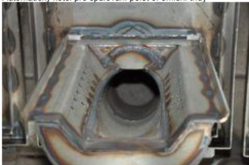
Detail peletového hořáku kotle 5. emisní třídy
